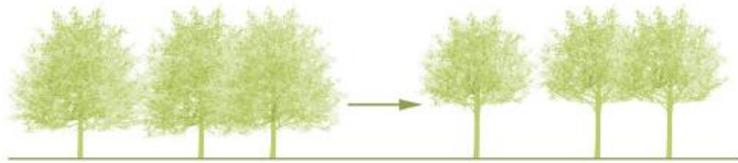
Die im Bestand sehr schweren und dichtkronigen Rosskastanien werden aufgeastet, um mehr Lichtraum und eine insgesamt attraktivere Aufenthaltsatmosphäre zu erreichen.
