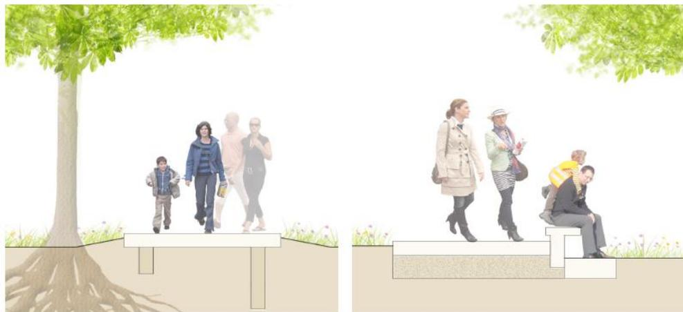
BESSELBAHN ALS WURZELBRÜCKE, DETAILSCHNITT M 1:25
