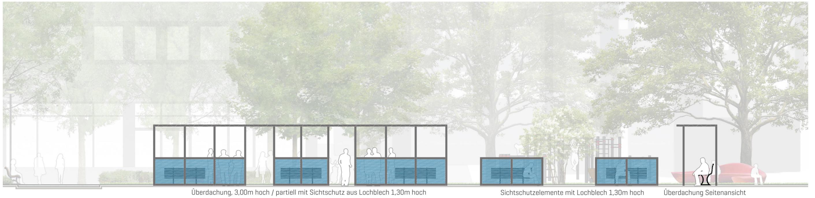
Überdachung, 3,00m hoch / partiell mit Sichtschutz aus Lochblech 1,30m hoch
